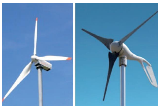
Rysunek 18 Turbiny o poziomej osi obrotu 185
